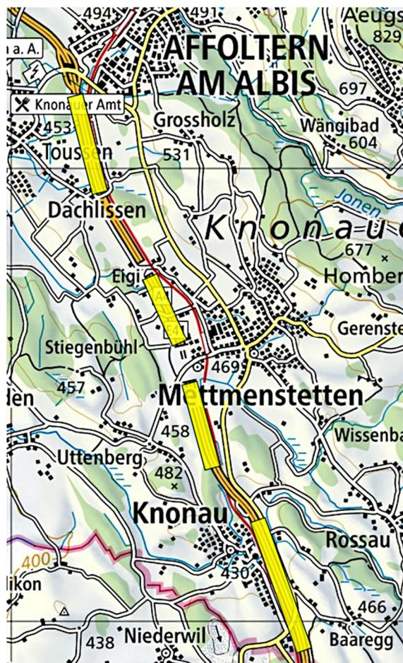
Für die PV-Überdachung fallen vier mögliche Teilstrecken der Autobahn A4 in Betracht: gelb markiert.
